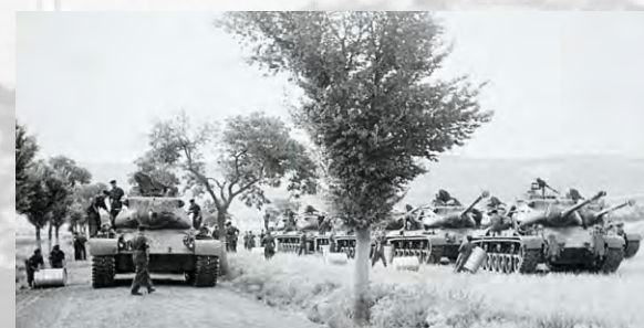
Unidad de carros repostando mediante bidones y bomba de trasvase.
